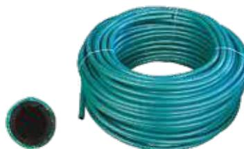
Tuyau renforcé en formulation spéciale de PU anti-abrasif et caoutchouc thermoplastique. Tuyau très léger, très flexible, pression de service 20 bar. Haute résistance à l'ozone, hydrocarbures, gras et produits chimiques légèrement agressifs. Vendu en couronne.
