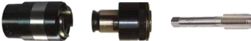
Le mandrin porte taraud doit être associé à une douille porte taraud sur laquelle sera fixé le taraud. Il existe plusieurs types de douille avec ou sans limiteur de couple. Les douilles à limiteur de couple permettent d'éviter la casse de taraud pour les trous non débouchants.
